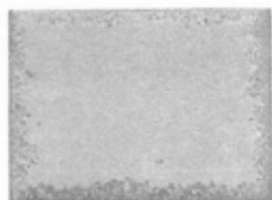
写真1 冷却保持時間なし 結晶はわずか。
