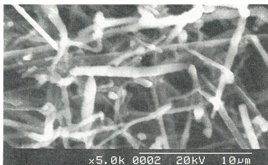
写真1 アルミナゾルでコーティングした炭化ケイ素ウィスカ (×5000)
