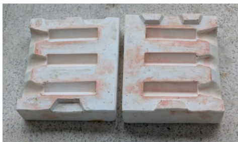
図1 鋳込みに使用した石膏型
