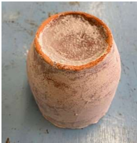
図 5 水素炎燃焼炉により得られた湯呑形状の施釉陶磁器
