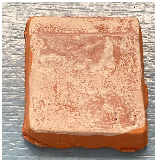
図 8 水素炎燃焼炉で焼成した釉薬テストピース
