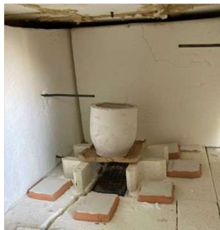
図1 焼成前の水素炎燃焼炉内の供試体
