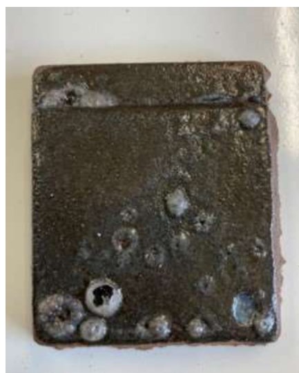
図 7 ブタンガス焼成によって気泡の発生した釉薬テストピース
