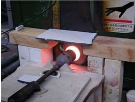
図 4 焼成中のブタンガス投入
