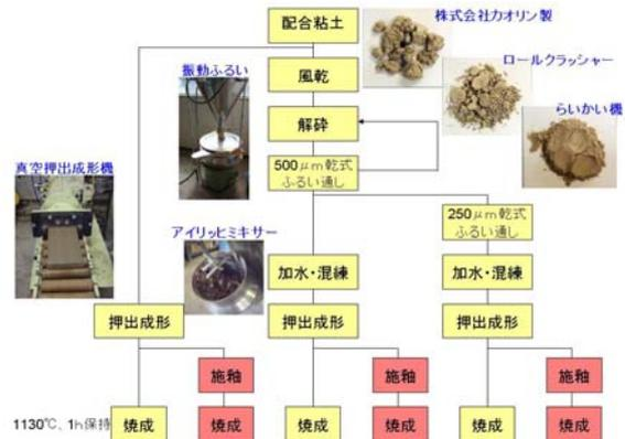
図2 試料の作製工程
