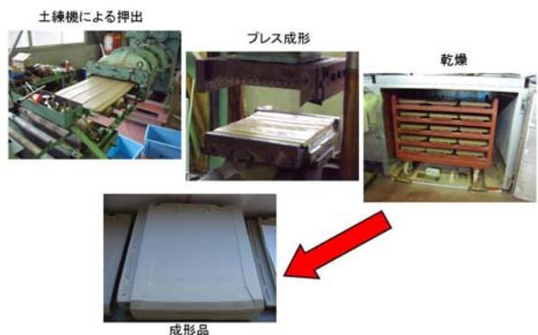
図12 実サイズの瓦の成形と乾燥
