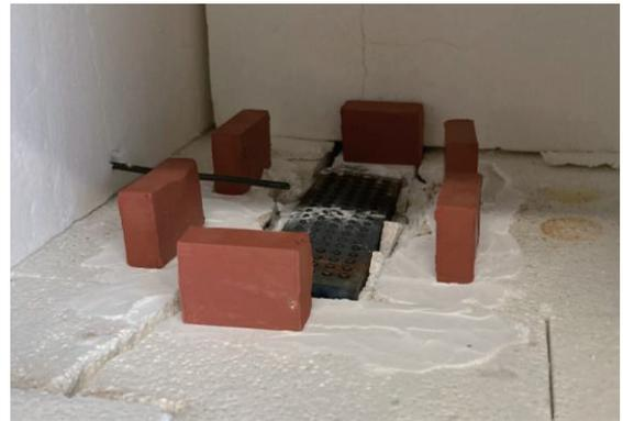
図5 焼成前の直方体形状成形体の配置
