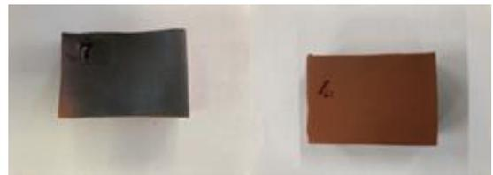
図6 テストピース焼成体Bの色合い(右は電気炉焼成品)
