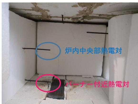
図1 水素炎燃焼炉内の様子
