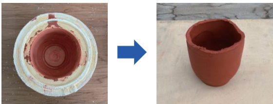
図3 排泥鑄込みに用いた石膏型(下半分)と脱型後の朱泥土成形体
