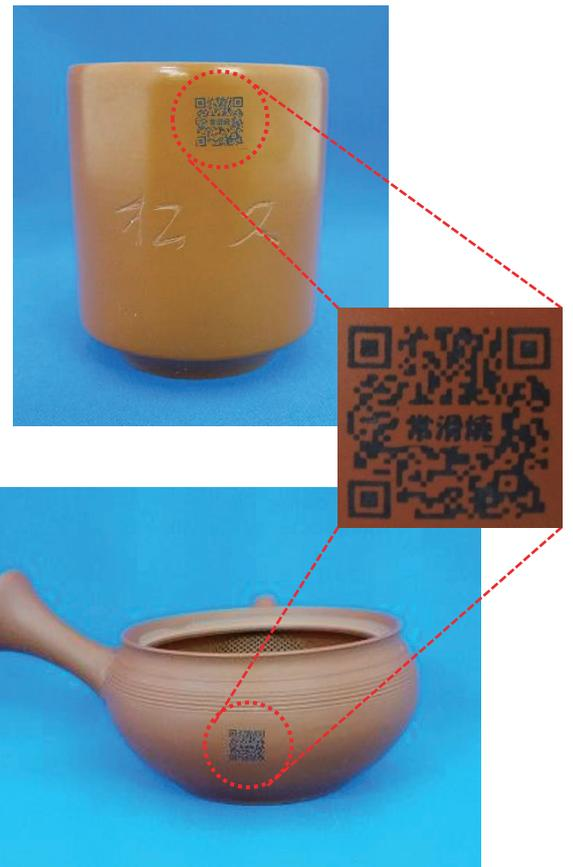
図4 湯呑み、急須に作製した“常滑焼”の文字を挿入した QR コード
