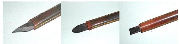
図 2 印刀 (左から 小刀、丸刃、丸刀)
