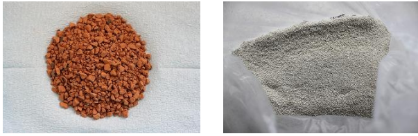
図2 シャモット（添加剤として使用） （左：陶器瓦シャモット、右：磁器シャモット）
