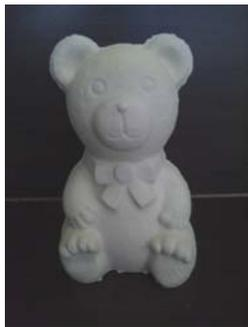
図2 試作鑄込み成型体 (1150℃)
