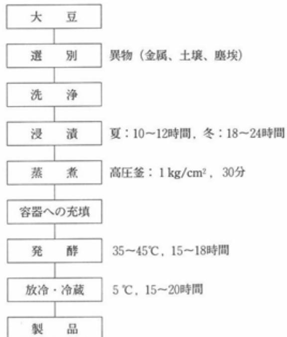
図1 糸引き納豆の製造工程
