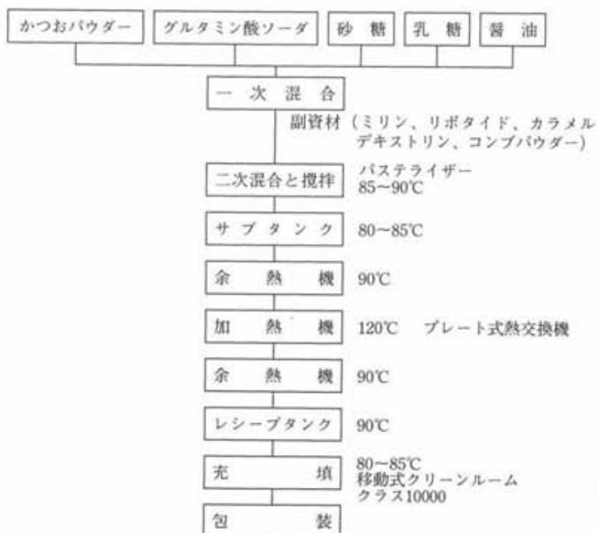
第1図 小袋詰ストレートつゆの製造工程
