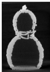
図 4 冷却治具未使用での造形物の断層像
