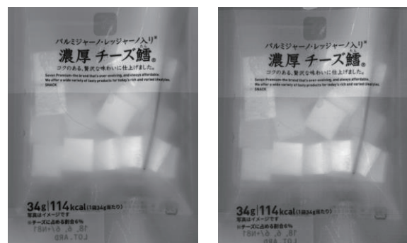
図 7 反射光源(偏光フィルターあり)での取得像 (左: 850nm、右: 950nm)
