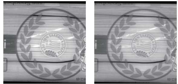
図 11 反射光用光源(偏光フィルターあり)での取得像(左: 850nm、右: 950nm)
