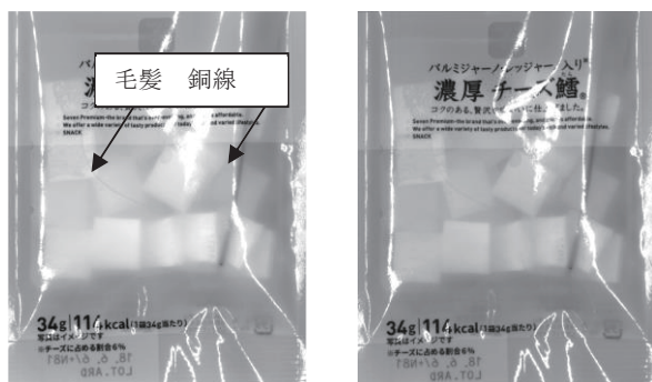
図 6 反射光源(偏光フィルターなし)での取得像 (左: 850nm、右: 950nm)
