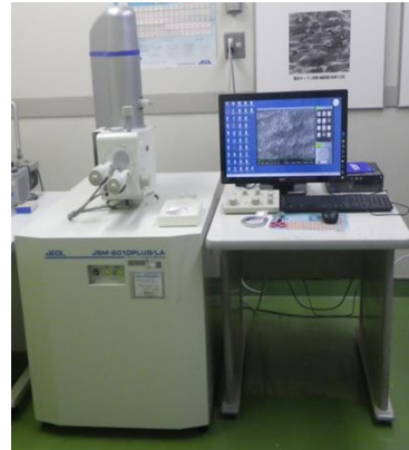
写真2 走査型電子顕微鏡—エネルギー分散型X線分析装置（SEM-EDS）
