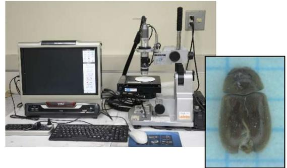
【走査型電子顕微鏡－エネルギー分散型X線分析装置（SEM-EDS）】
