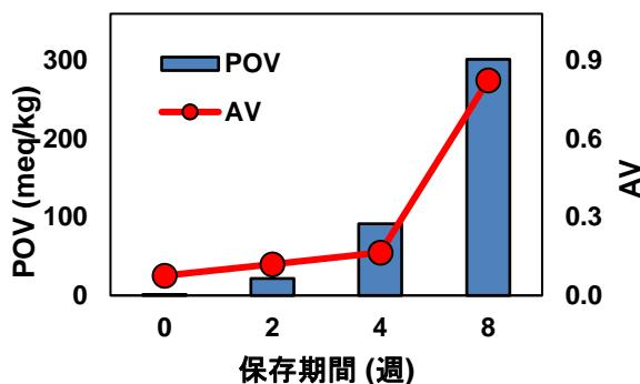
図1 なたね油の劣化 (50°C暗所)
