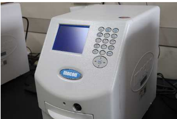
図1 水蒸気透過度測定装置
