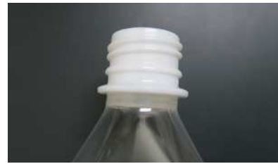
図 2 ホット充填用ペットボトルの飲み口 白色であるのは熱処理によって PET の結晶化度を高めているため。
