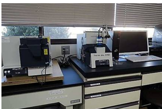
図 1 導入された試料観察型熱分析装置
