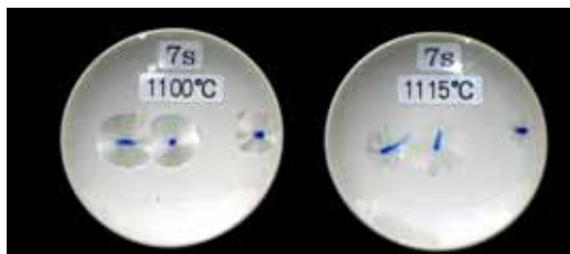
図2 結晶温度1100,1115℃焼成物
