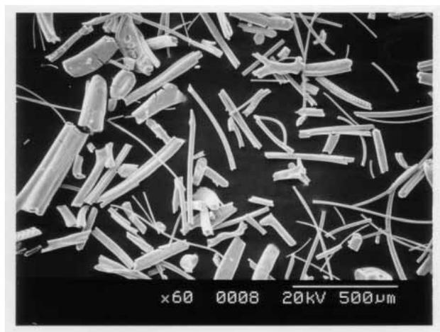
写真1 ZrO<sub>2</sub>ファイバーの電子顕微鏡観察
