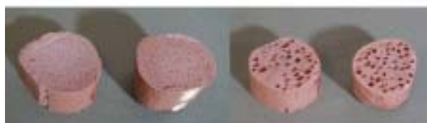
写真5 1150℃酸化焼成試料の結果外観
