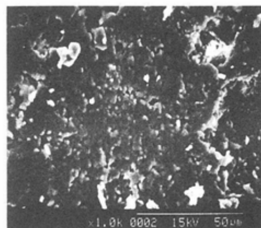
写真1 SEM写真（コーディエライトハニカムセル内部表面・コーティング前）
