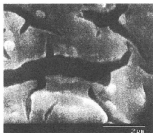
写真5 SEM写真(コーディエライトハニカムセル内部表面・コーティング後 熱処理:450°C)
