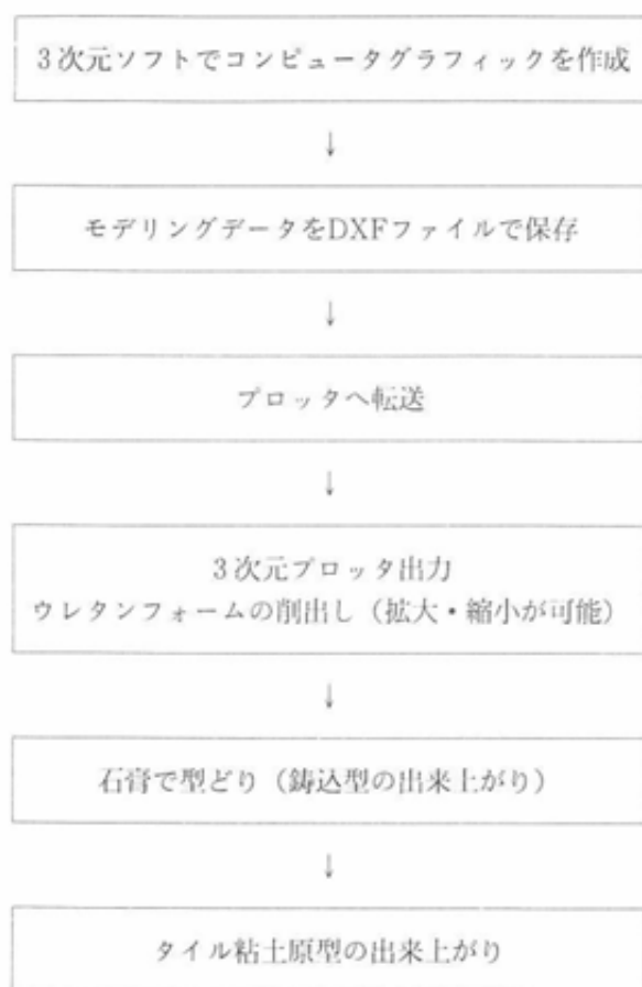
図2 原型の製作手順
