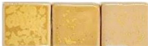
図5 1280°C焼成後 1100°Cで1h 温度保持の焼成グラフと焼成したテストピース
