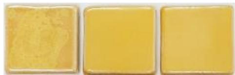
図4 1250°C焼成、自然冷却の焼成グラフと焼成したテストピース
