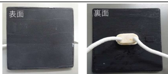
図1 CNF・CNT・グラフェン複合体分散セラミックスラリーを塗布したセラミックヒーター
