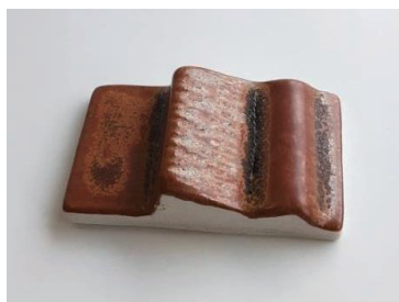
図12 朱金地釉2回目の再現試験 (レリーフ型テストピース)
