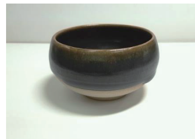
図9 織部釉を用いた再現試験の例 (食器型テストピース)
