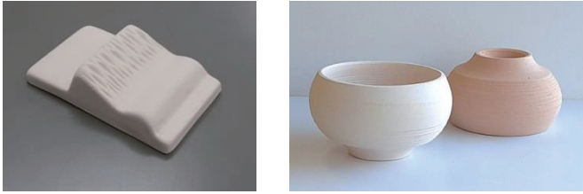
図5 レリーフ表現等を含んだレリーフ型テストピース(左) 食器型テストピース(右)
