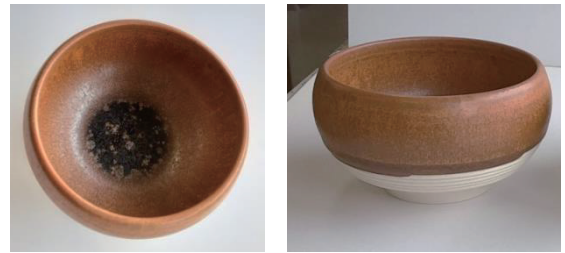
図13 朱金地釉2回目の再現試験 (食器型テストピース)
