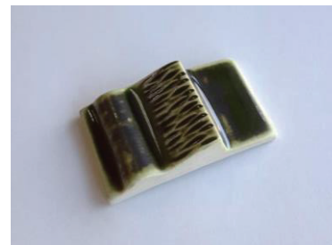
図8 織部釉を用いた再現試験の例 (レリーフ型テストピース)
