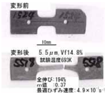
図10 5.5 μmSiC(Vf14.8%)/AZ91Dマグネシウム合金複合材料の変形前および変形後の試験片概観
