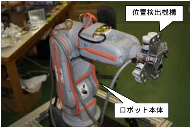
図4 機械式位置計測機構を搭載したロボット
