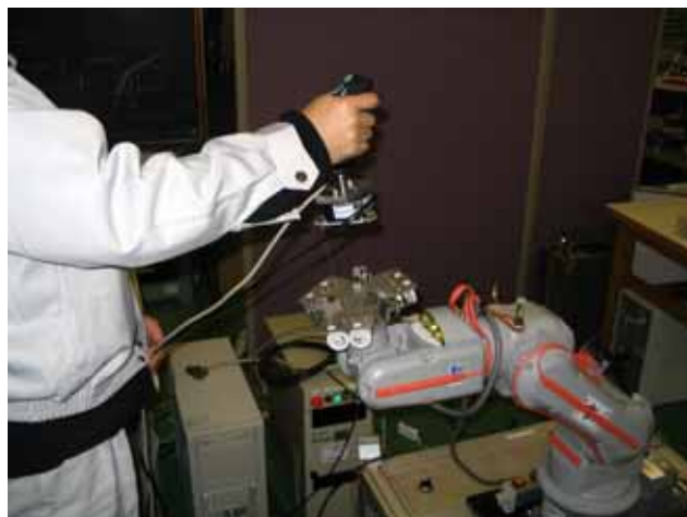
図8 教示機構・ロボット一体化後の動作試験
