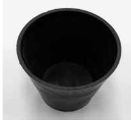
図7 粉体（柔細胞）から調製したカップ型成形物
