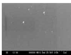
図4 未着色PEDOT膜 SEM像
