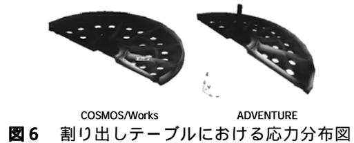
図6 割り出しテーブルにおける応力分布図
