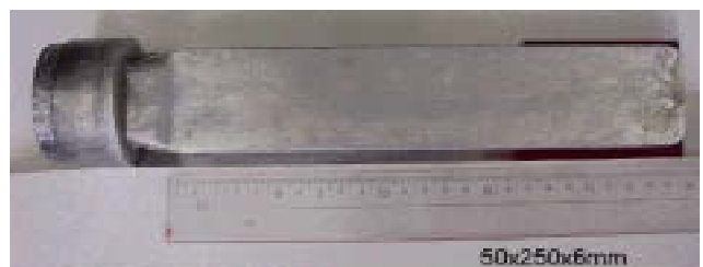
図11 板状金型による試作品
