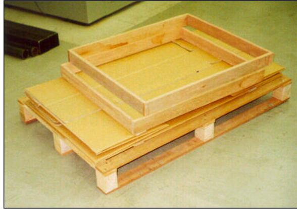
写真1 重量品向けリターナブル容器（組立時及び返却時）
