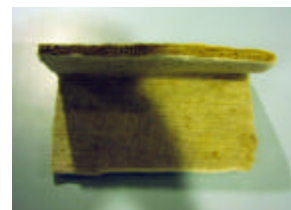
d レーヨン不織布・木材ファイバー (折り返してニードリングしたマットの断面)
