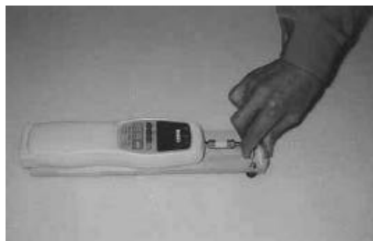
写真1 抓む力の測定風景
