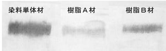
図4 湿潤摩擦による摩擦用白綿布の汚染状態
