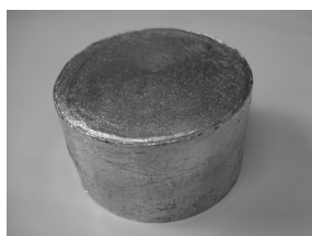
図3 プリカーサ作製用成形体(AZX911 マグネシウム合金)
