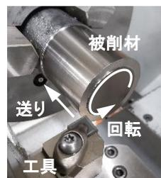
図1 加工試験の様子
