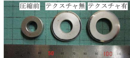
図4 リング圧縮試験後の供試材外観(圧縮率 60%)
