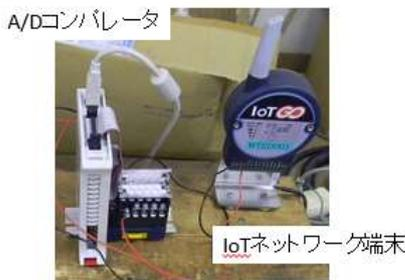
図2 A/DコンパレータとIoTネットワーク端末
