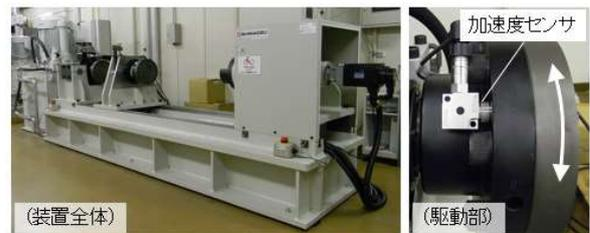
図 1 ねじり疲労試験機と加速度センサ
