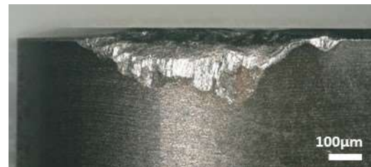
③BN2000LT、Vc200m/min、切削距離 88m
