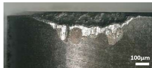
④BN2000LT、Vc300m/min、切削距離 18m
