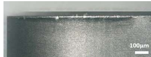
①BN7000、Vc200m/min、切削距離 1757m
