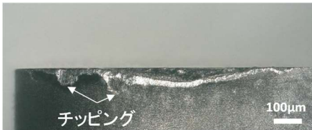
①BN7000LF、Vc300m/min、切削距離 1757m
