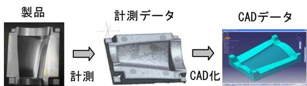
図1 リバースエンジニアリングの流れ
