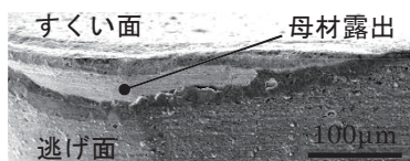
図 3 0.9cm 3 切削後のコーティング工具
