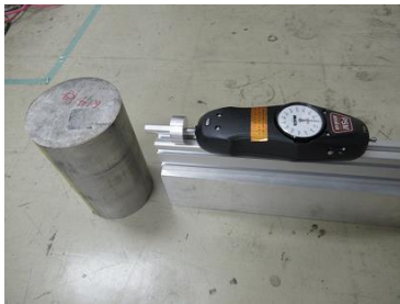
図 3 転倒限界荷重についての実験風景
