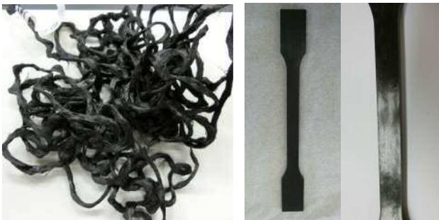
図1 射出前の試料と成形品(条件B)
