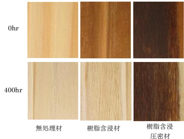
図3 耐候性試験による外観変化
