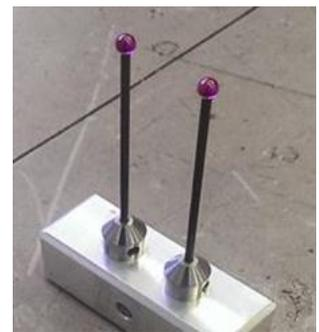
図3 縮尺補正用ゲージ
